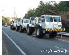
振動を与えて探す「物理探査」
